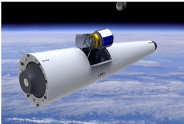
Рис. 4. Проект многоразовой одноступенчатой ракеты-носителя «Корона» с широким применением в конструкции композиционных материалов (АО «ГРЦ Макеева», Россия)
