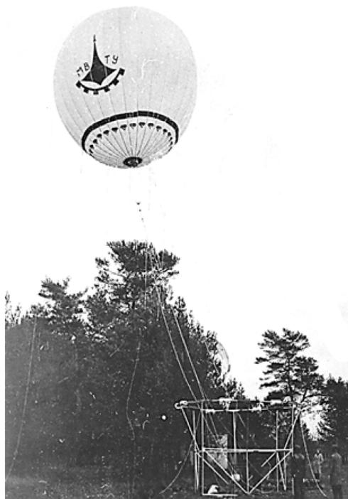
Рис. 3. Летные испытания привязного аэростата.
