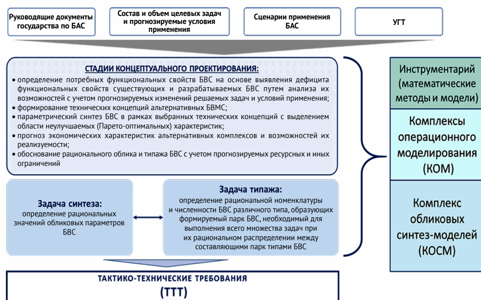
Рис. 2. Обобщенная схема формирования тактико-технических требований БВС с применением технологии концептуального проектирования
