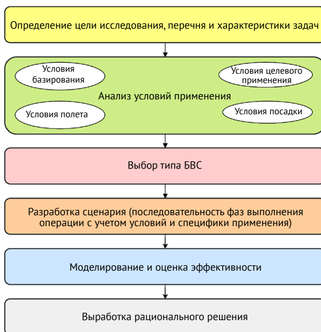
Рис. 5. Схема процессов моделирования на основе сценарного подхода
